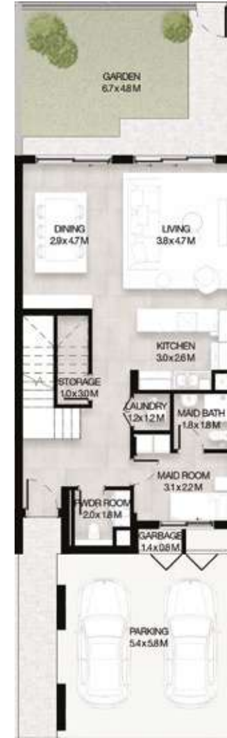
GROUND LEVEL الطابق الأرضي
